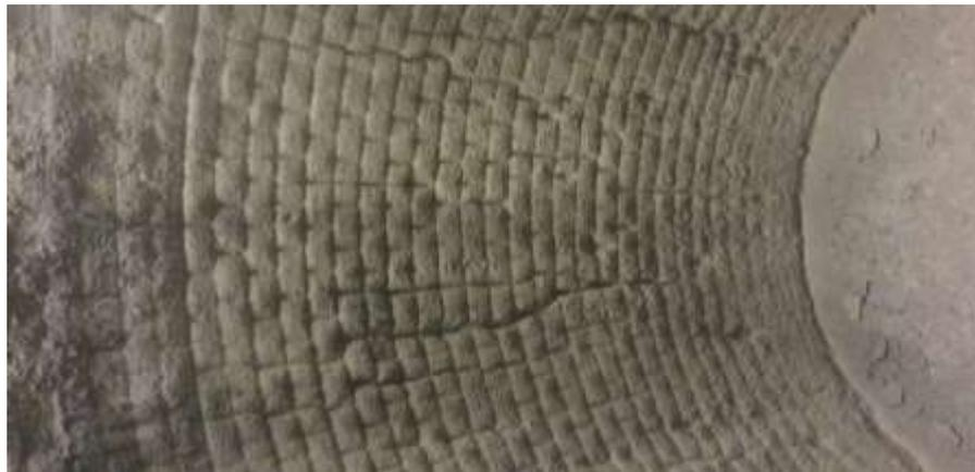
Трещины и сколы могут возникать как при нагреве, так и при остывании футеровки.
