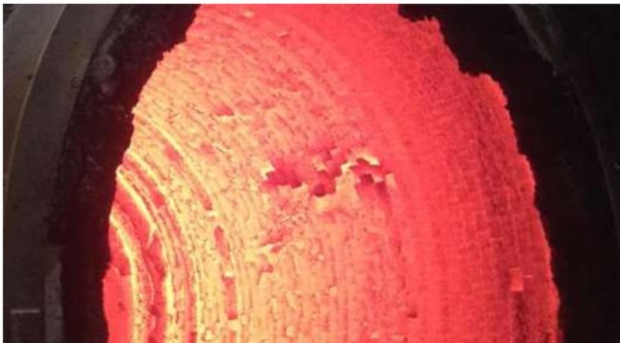
Особенности разрушения футеровок в оборудовании разного размера
